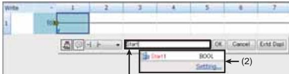
1. Klicken Sie im Kontaktplan-Editor auf die Position, an der das Element eingefügt werden soll, und betätigen Sie die Taste **[F5]**
